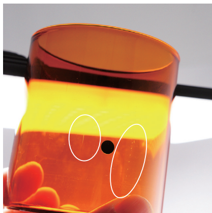
左: 気泡 (資材製造時 上下に伸びている) 右: 軽微なこすれ傷
